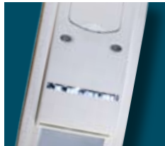
De detector is van het combitype en detecteert ook sabotage en pogingen tot afdekken.
